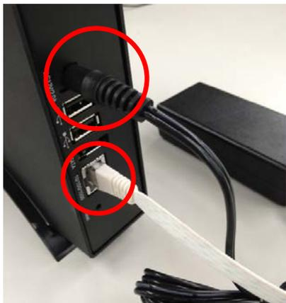
ネットワーク機器(無線ルータ等)の LAN ポートと RockDisk Next の LAN ポートを付属の LAN ケーブルで接続します。接続後、付属の AC アダプタを RockDisk Next に接続すると電源が自動的に ON になります。起動中は本体前面の STATUS LED ランプが点滅します。青色 LED の常時点灯になったら、起動完了です。
