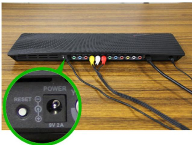
ボルカノフロー本体裏面に電源ケーブルを接続します。
