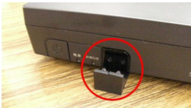
接続するAV機器（HVTR-BTL）の赤外線受光部の近くに、IRケーブルの先端を両面テープで貼り付けます。
