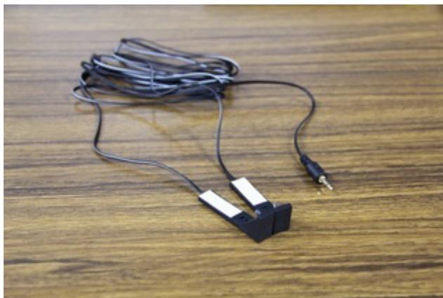
IRケーブルは、ポルカノフローに接続したAV機器のリモコン信号を送信するためのケーブルです。ポルカノフローのIR端子にIRケーブルを接続し、IRケーブルの先端をAV機器の赤外線受光部付近に両面テープなどで貼り付けます。こうすることで、普段のリモコン操作と同じ感覚でポルカノフローに接続したAV機器を遠隔操作できるようになります。
