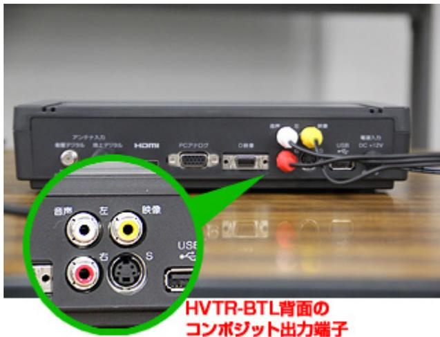
赤・白・黄のコンポジット端子は多くのAV機器が備えている一般的な映像端子です。AV機器側のコンポジット出力端子と、ボルカノフローのコンポジット入力端子をコンポジットケーブルで接続します。
