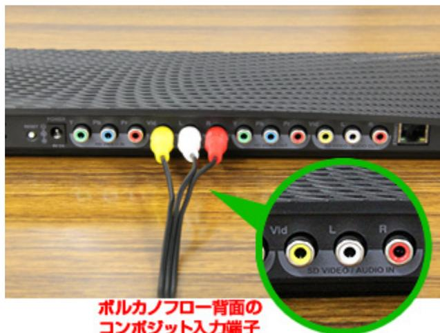
次に、ボルカノフローの入力端子にもう片方のコンポジットケーブルを接続します。
