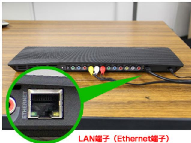
ボルカノフローとネットワークルーターをLANケーブルで接続します。ボルカノフローは無線LAN接続にも対応していますが、初めて設定を行う場合は有線LANを使用しますので、必ず有線LAN接続をしてください。
