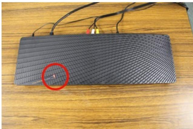
電源ケーブルを接続すると自動的に電源が入り、POWERランプが赤色に点滅します。しばらくすると点滅から常時点灯に変わります。
